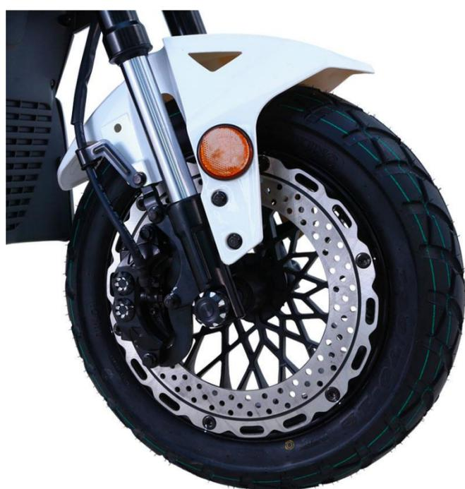
Verificar periódicamente el líquido de freno. Si la potencia del frenado disminuye, se debe revisar que no exista ninguna fuga de líquido en la manguera.
